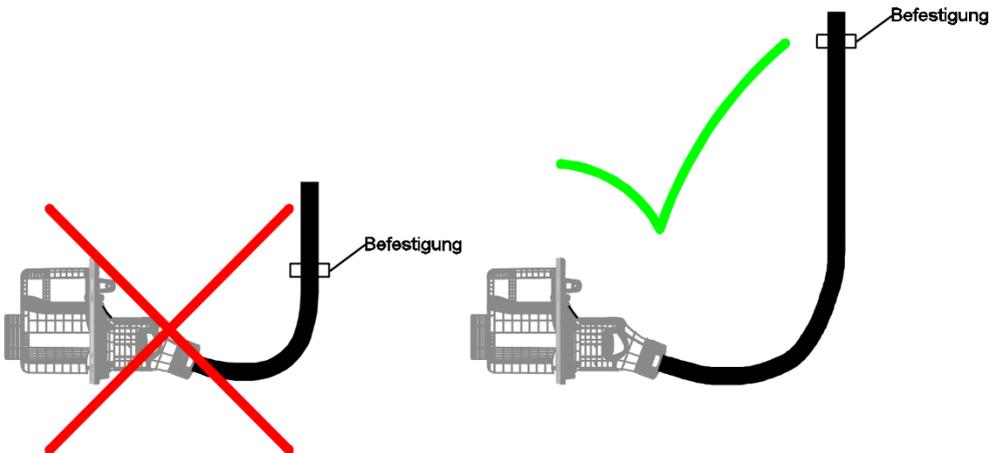
Um Beschädigungen am Multifunktionssystem oder Fahrzeug zu vermeiden, darf kein unkontrollierter Auswurf stattfinden.
